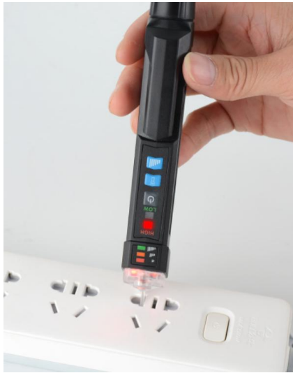
零线/火线测试
